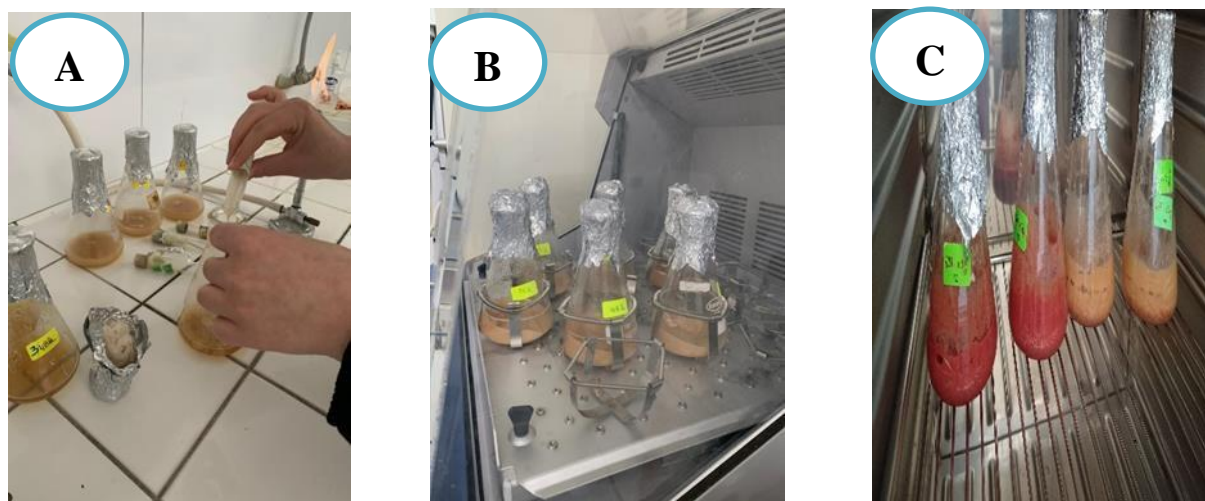
Figure 20. Les étapes de la fermentation : inoculation (A), incubation agité (B) et statique (C).
